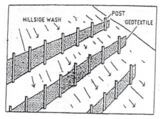
Fig. 6 : SILT FENCE ARRAY ON A STEEP HILLSIDE
